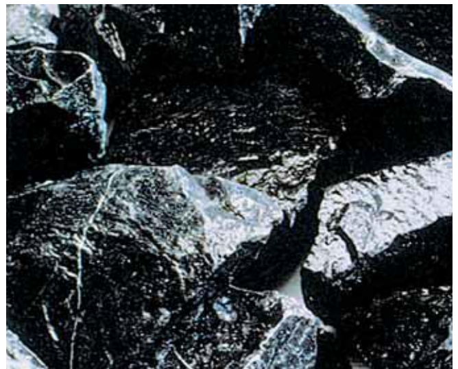
Geschmolzenes Vulkangestein bildet die Basis für die Steinwolle-Flocken Fillrock.
